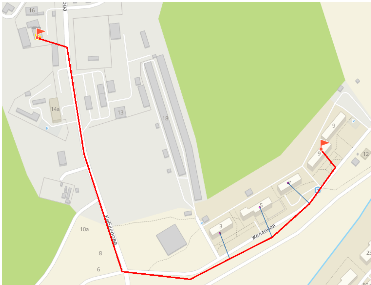
Рисунок 4.72 – Путь движения теплоносителя от источника тепловой энергии до конечного потребителя, в зоне действия котельной №22 (рисунок П46.1 МУ)
