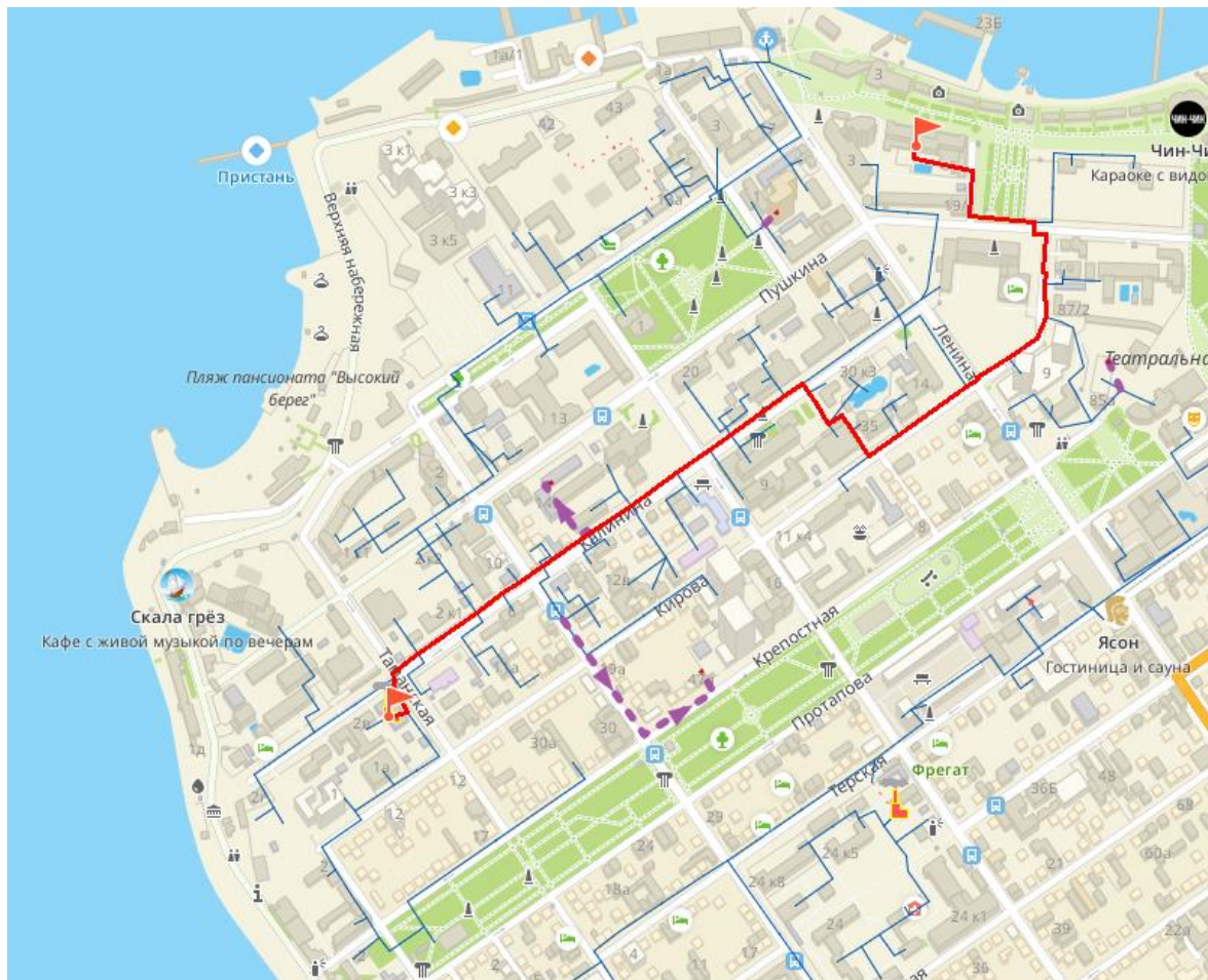
Рисунок 4.82 – Путь движения теплоносителя от источника тепловой энергии до конечного потребителя, в зоне действия котельной №3 (рисунок П46.1 МУ)
