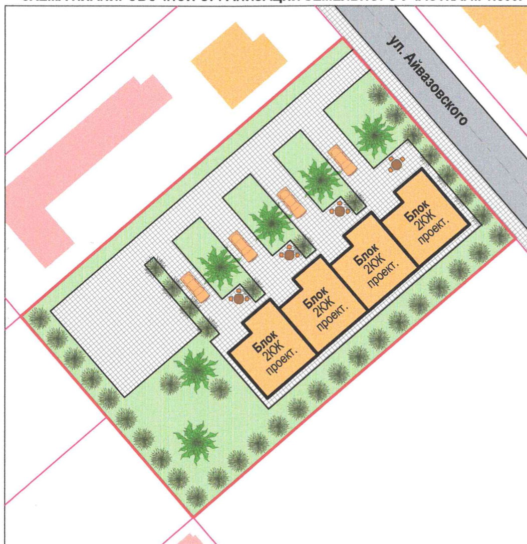
СХЕМА ПЛАНИРОВОЧНОЙ ОРГАНИЗАЦИИ ЗЕМЕЛЬНОГО УЧАСТКА. М 1:500.
