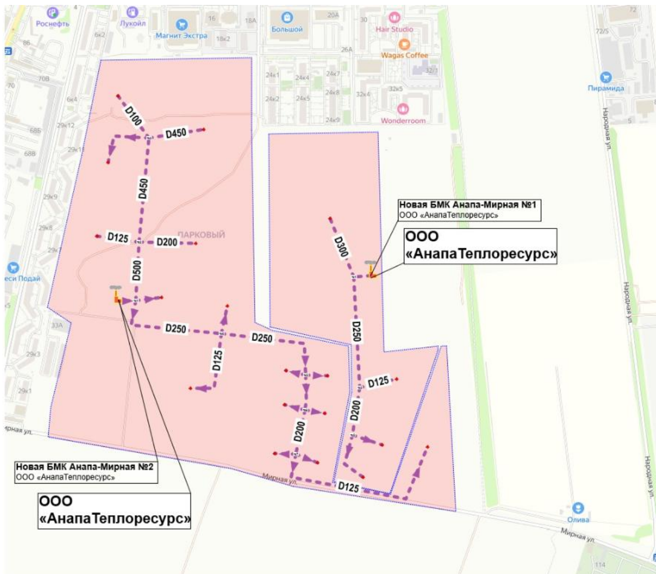
Рисунок 16 – Схема расположения источников тепловой энергии и тепловых сетей от котельных АО «АнапаТеплоресурс»
